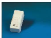
GS610震动探测器可通用于暴力入侵的门，窗，墙壁和屋顶。可通过360° 轴垂直水平安装。探测器还可先磁铁开关，对平开的门窗进行双重保护。(尺寸：72×27×21mm)
