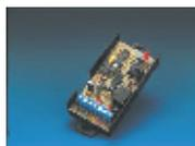
GS614震动分析器可设置灵敏度和脉冲计数，LED指示灯可指示报警及测试状态。1个分析器最多可接20个震动探测器。
